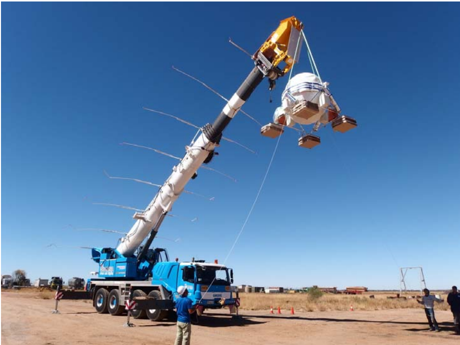
・写真3：打ち上げ時に使用する放球用クレーン車で吊り下げるリハーサル (アリススプリングス気球放球基地にて) © GRAINE collaboration
