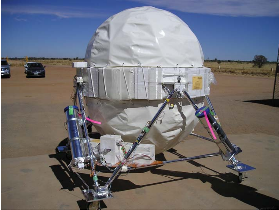
・写真2：エマルジョン望遠鏡を球形与圧容器に実装しゴンドラに搭載した姿 (アリススプリングス気球放球基地にて) © GRAINE collaboration
