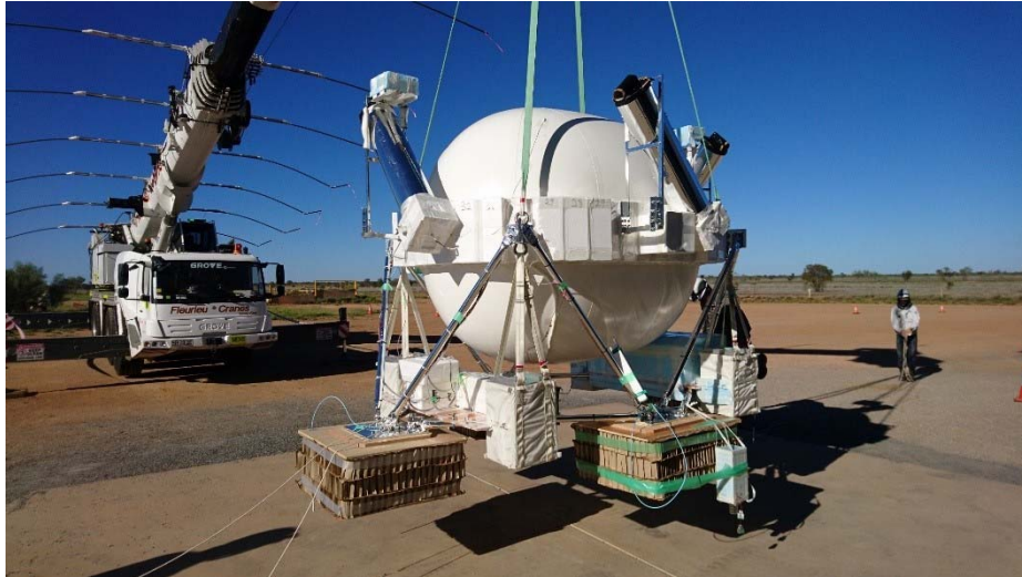
図 3: 気球実験最終準備完了時の様子。与圧容器シェルを閉じた状態。スターカメラの迷光よけフード(銀色の筒)が3方位それぞれ見える。
