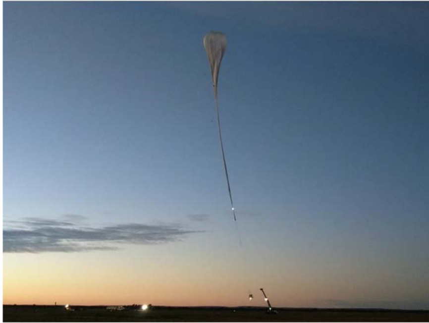
図 5: 気球放球時の様子。4月26日現地時間6:33(UTC+9.5)。気球の頭部から尾部(発光部の直上)まで130m。上空での気球の満膨張時の体積は30万 \text{m}^3 。その下にパラシュート、つり紐を介してエマルジョン望遠鏡(下側の発光部)が吊り下がっている。
