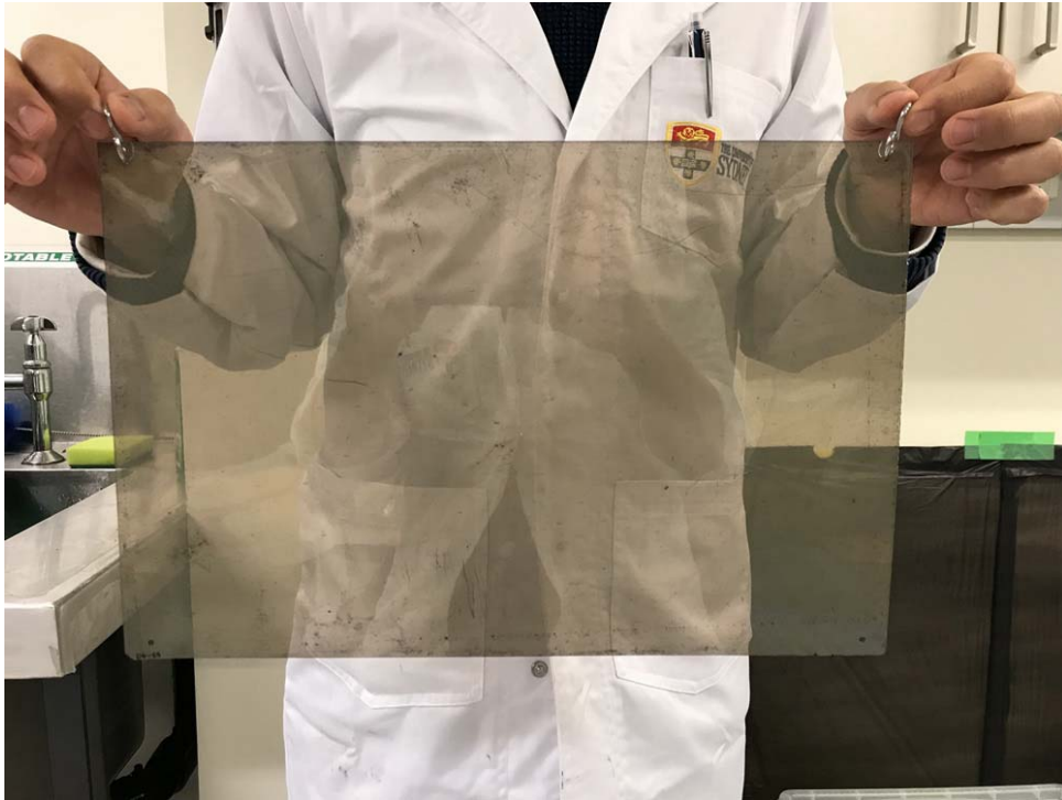
図 7: 現像後の飛翔エマルジョンフィルム。
